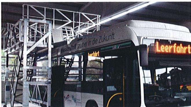
Abb. 1: Wartungsarbeiten am Wasserstoffbus finden überwiegend im Dachbereich statt.
